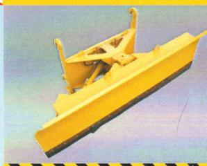
Резиновая сменная износостойкая пластина обеспечивает плотное прижатие отвала к очищаемой поверхности и защиту от удара об выступающие элементы дороги. Замена производится одним оператором. Ширина отвала 2880 мм. Угол поворота 55°.
